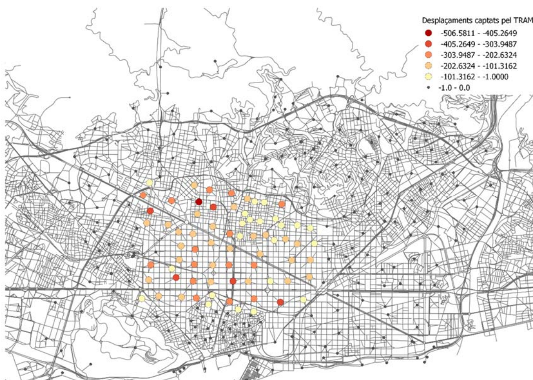
Figura 5. Número de desplaçaments captats pel tramvia per cada origen del model de simulació de l'estudi de trànsit (Font: Elaboració pròpia a partir de les dades de les matrius origen-destí facilitades per l'Ajuntament)
